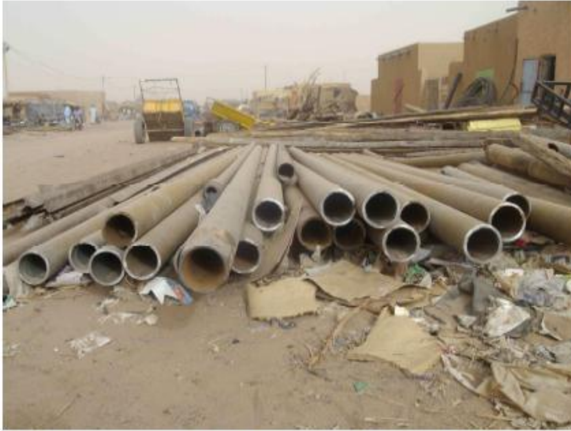
Tubes de forage contaminés ( 2,5 \mu\text{Sv/h} et 4,9 \mu\text{Sv/h} au contact, soit 25 à 49 fois plus que le niveau naturel). Débit de dose à 50 centimètres : 1,7 \mu\text{Sv/h} .
